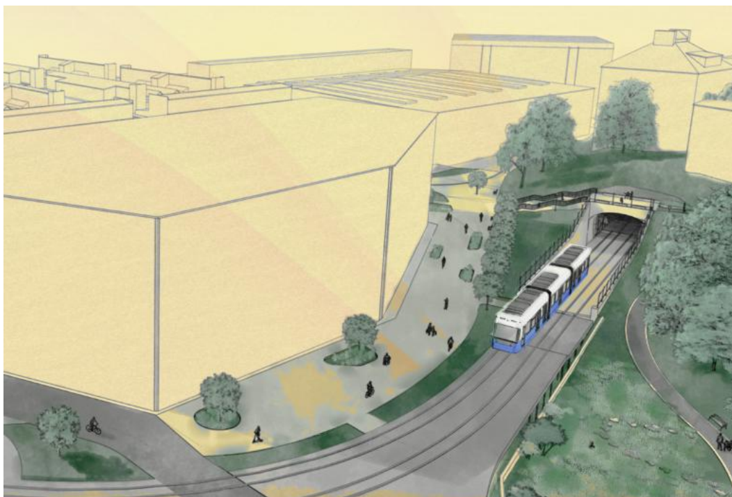
Figur 36. En idébild från tidigare planeringskede som visar hur tråget kan utföras med ett tätt genomskiktligt räcke och spårnära låga skärmar. [källa AFRY]
