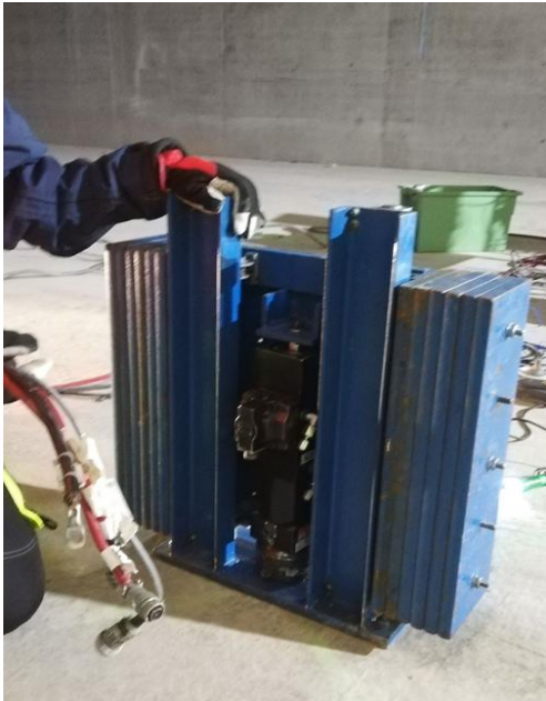
Figur 17. Vibrator som kan skapa vibrationer som motsvarar en förutbestämd vibrationssignal av exempelvis fordonspassage.
